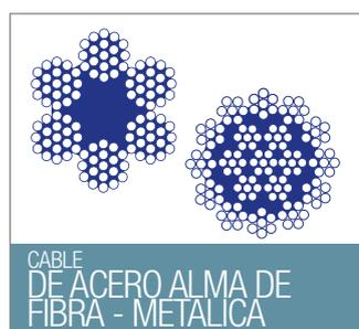
CABLE DE ACERO ALMA DE FIBRA - METÁLICA
