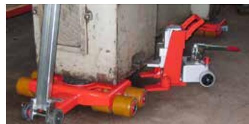
Ruedas con rodamientos que garantizan una fácil traslación.
