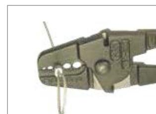
4. Concretar longitud del ojal del cable
