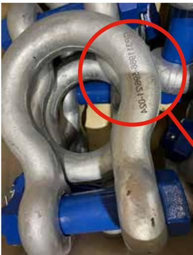
MARCAJE LASER. INSPECCIONADOS Y MARCADOS CON EL CÓDIGO DE TRAZABILIDAD.
