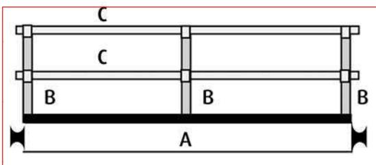
Set de barandillas de montaje rápido compuesto por 2 verticales B y 2 barandillas C para cada lado.
