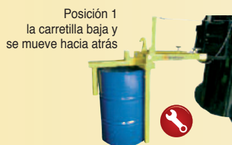
REF. 3058 Para bidones de 200 lts de chapa Dimensiones (L x A x H) 1.700 x 1.025 x 700 mm Carga 400 kg • Peso 75 kg Radio de giro 90°
