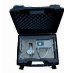
Medición de la calidad del aire comprimido
