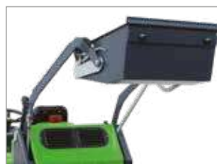
SISTEMA HIDRÁULICO DE DESCARGA DEL DEPÓSITO
