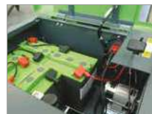
ALOJAMIENTO DE BATERÍAS (1280 E)
