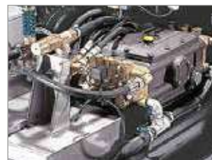
BOMBA DE LINEAL CON DOS CABEZALES DE LATÓN Y SEIS PISTONES DE CERÁMICA.
