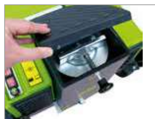
SACUDIDOR DE FILTRO
