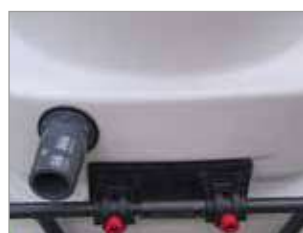
CONEXIÓN MANGUERA DRENAJE
