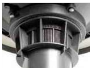
SISTEMA ANTIESPUMA INTEGRADO
